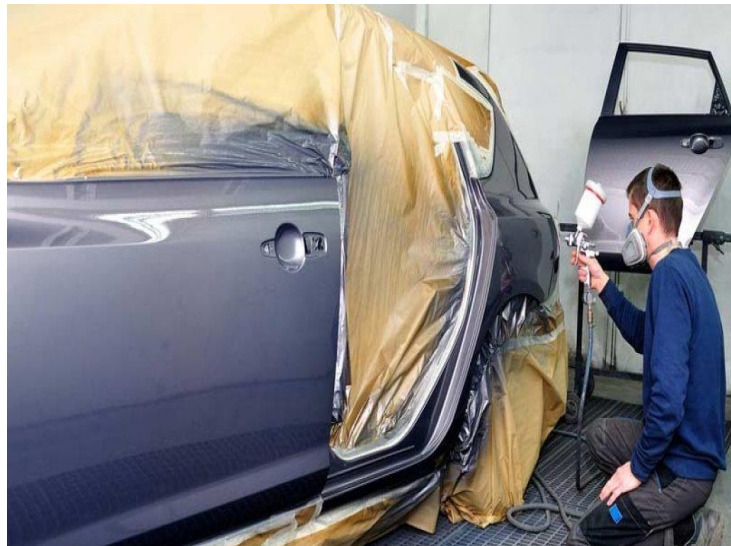
Figura 4-13: Aplicación de recubrimiento automotriz dentro de una cabina de pintura en aerosol
